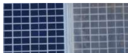
شکل ۳- پنل تمیز و پنل آلوده در انتهای روز
