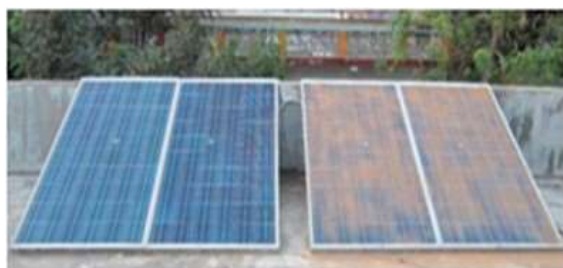
شکل ۸- پنل‌های استفاده شده برای مقایسه اثر گردوغبار، شن بر خروجی پنل فتوولتائیک
