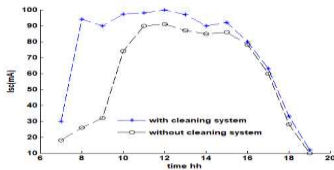
شکل ۱۰- تاثیر گردوغبار بر جریان بر حسب زمان (پنل تمیز - پنل آلوده)
