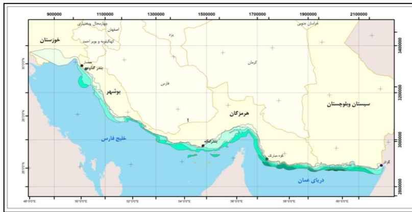
شکل ۵- تقسیم‌بندی سواحل جنوبی ایران بر مبنای عمق‌سنجی در محیط GIS
