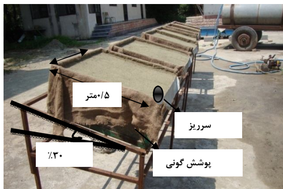
شکل ۲. نمایی از شرایط آزمایشگاهی مورد استفاده در تحلیل اثر مصرف نوع پلی آکریل آمید بر هدررفت خاک
