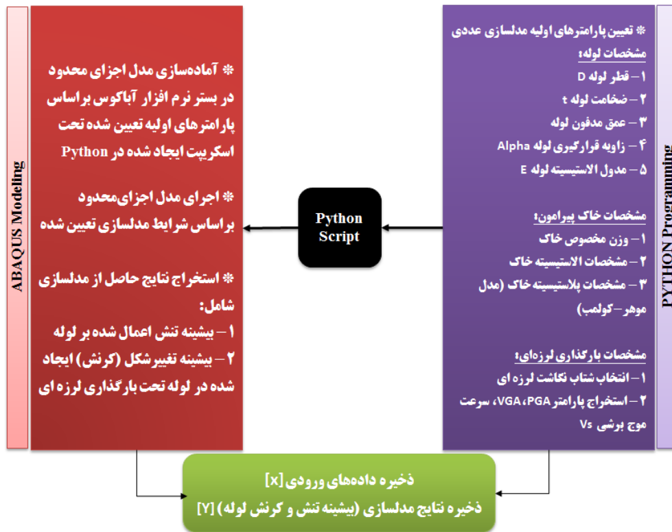
شکل ۴. فرایند مدل‌سازی عددی رفتار لرزه‌ای لوله مدفون براساس متغیرهای موثر در بستر (ABAQUS-PYTHON)
