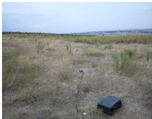
شکل ۳- اندازه‌گیری رطوبت خاک با دستگاه TDR
