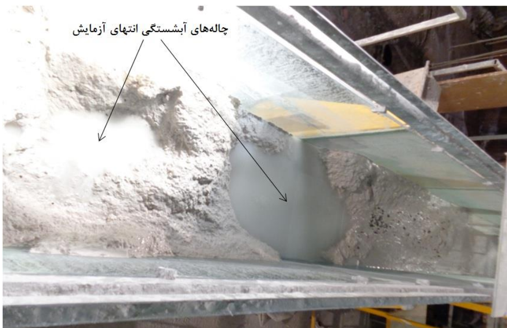
شکل ۴. چاله‌های آبشستگی ایجاد شده در انتهایی آزمایش
