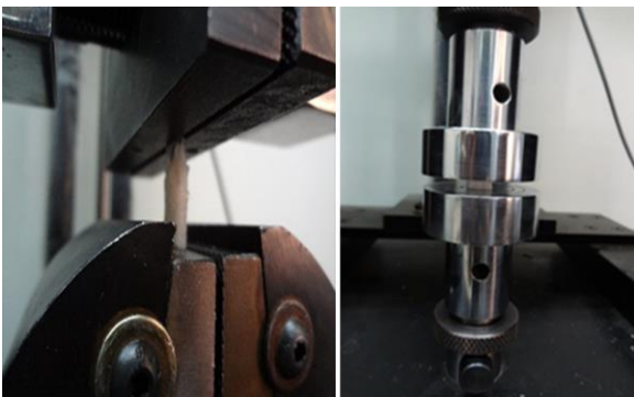
تصویر ۲- الف: آزمایش تحمل فشار؛ تصویر ۲- ب: آزمایش تحمل کشش بر روی بافت لیگامان کف پای
