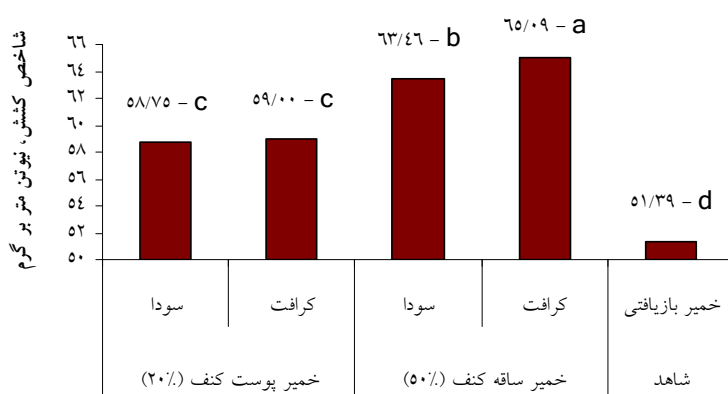
شکل ۴. شاخص کشتی کاغذهای حاصل از اختلاط خمیر کاغذهای کنف با خمیر کاغذ بازیافتی (حروف مشابه در هر ستون نشان دهنده عدم اختلاف معنی دار بر مبنای آزمون دانکن در سطح ۱ درصد است)
