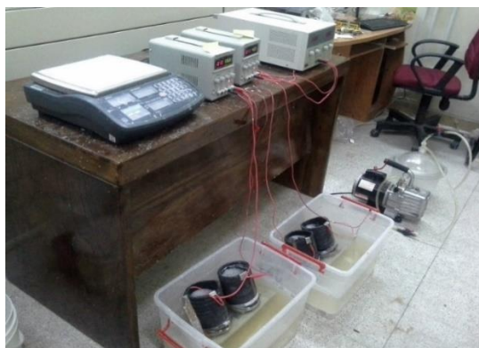
شکل ۳. نمای از آزمایش انتشار تسریع شده یون کلراید
