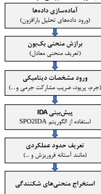
شکل ۲- فلوچارت مراحل روش SPO2FRAG برای تخمین منحنی شکنندگی
