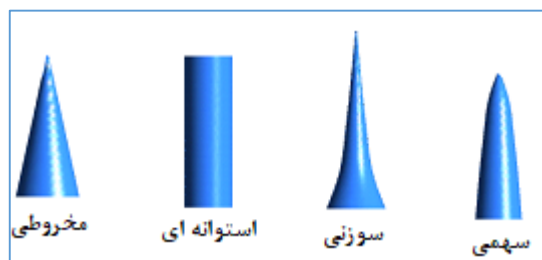
شکل ۱: شماتیک هندسه فین‌های بررسی شده
