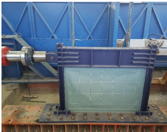
شکل ۱۱- وصل ابتدایی نمونه به شاسی زیر و چک
