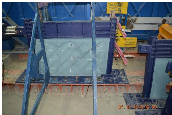
شکل ۱۹- نمایی از سیکل رفت دیوار برشی
