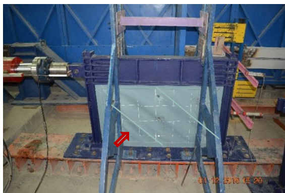
شکل ۱۷ - ایجاد خطوط کشش قطری بر روی نمونه
