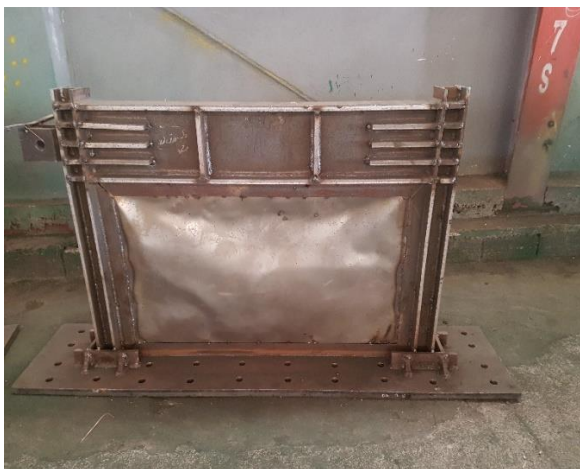
شکل ۳- دیوار برشی فولادی پس از جوشکاری نهایی
