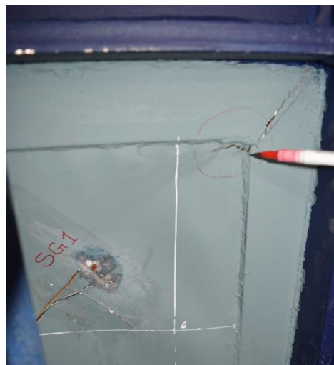
شکل ۱۶- گسترش ترک در ورق فولادی
