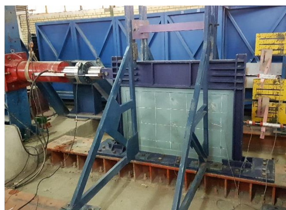
شکل ۱۲- نحوه قرارگیری ابزارهای اندازه گیری بر روی نمونه و همچنین مهار جانبی
