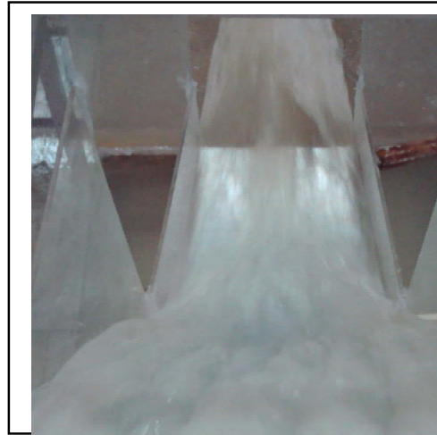
شکل ۵- جریان آشفته بر بدنه ی سرریز در آزمایش دهم
