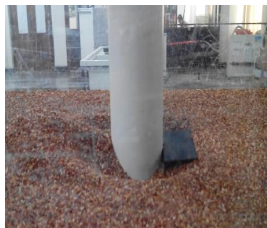
شکل ۴- قرار دادن پایه پیل در رسوبات کف و قرار دادن صفحات محافظ در جلوی پایه
