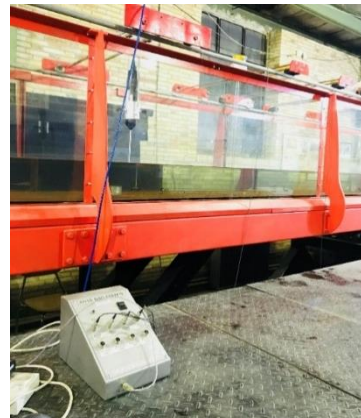
شکل ۶- نمایی از نحوه اندازه‌گیری عمق جریان با استفاده از دستگاه عمق‌سنج و نمایش تجهیزات آن.
