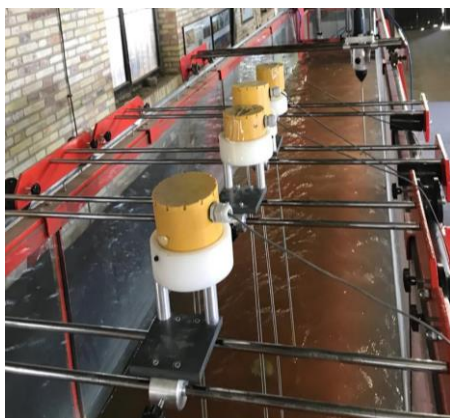
شکل ۶- نمایی از نحوه اندازه‌گیری عمق جریان با استفاده از دستگاه عمق‌سنج و نمایش تجهیزات آن.
