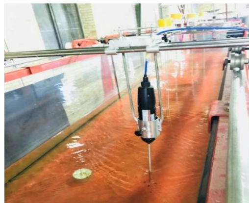
شکل ۴- نحوه استقرار دستگاه سرعت سنج Vectrino برای جمع‌آوری داده‌ها پیرامون پایه تخریبی موجود در کانال.
