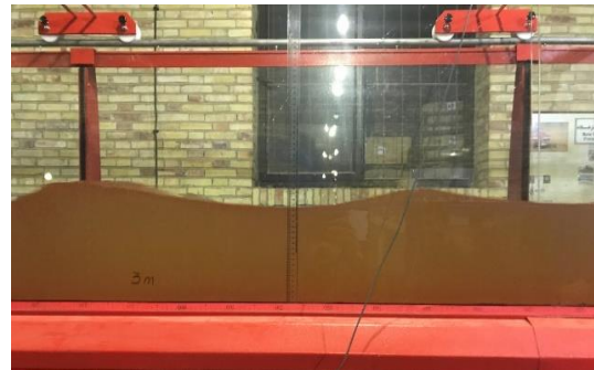
شکل ۹- نمونه‌ای از نمایش موج نوسانی در کانال افقی آزمایشگاه سازه‌های هیدرولیکی دانشگاه آزاد اسلامی واحد کرمان.
