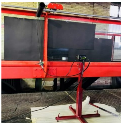
شکل ۵- نمایی از نحوه اندازه‌گیری سرعت جریان با استفاده از PIV و تجهیزات مربوط به آن.
