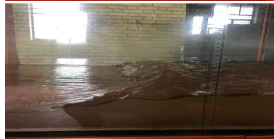
شکل ۱۰- نمونه‌ای از نمایش موج شکننده در کانال شیبدار آزمایشگاه سازه‌های هیدرولیکی دانشگاه آزاد اسلامی واحد کرمان.
