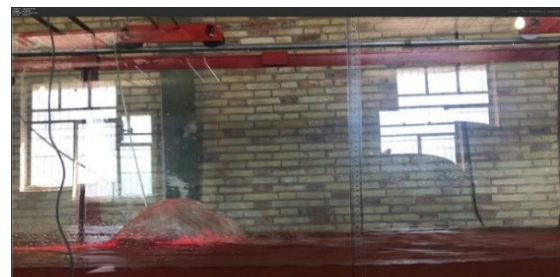
شکل ۹- نمونه‌ای از نمایش موج نوسانی در کانال افقی آزمایشگاه سازه‌های هیدرولیکی دانشگاه آزاد اسلامی واحد کرمان.
