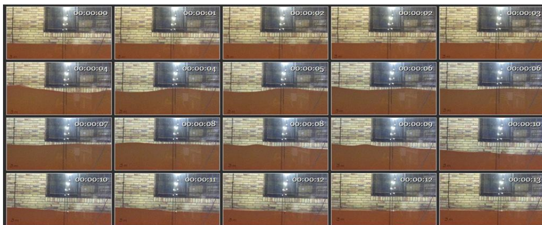
شکل ۱۱- نمایش نحوه تشکیل و پیشروی موج نوسانی در طول کانال افقی آزمایشگاه هیدرولیک دانشگاه آزاد اسلامی واحد کرمان.
