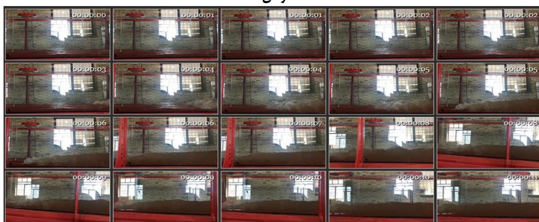
شکل ۱۲- نمایش نحوه تشکیل و پیشروی موج نوسانی در طول کانال شیبدار آزمایشگاه هیدرولیک دانشگاه آزاد اسلامی واحد کرمان.
