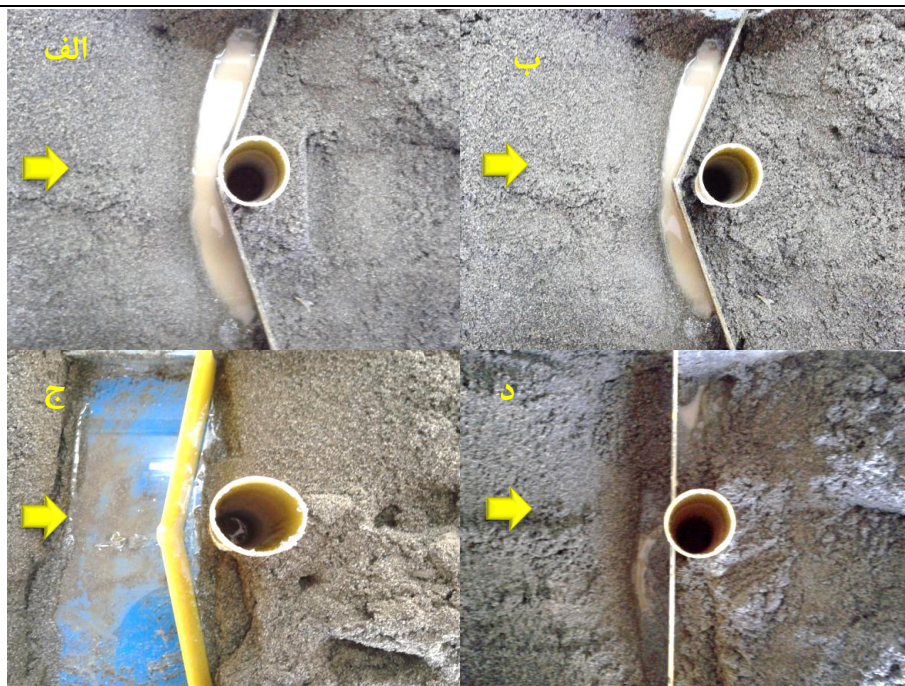
۴-نمایی از استقرار آستانه الف) آستانه‌ی اریب در L=0 ، ب) آستانه‌ی اریب L=2.5 cm، ج) آستانه‌ی اریب L=5 cm و د) آستانه‌ی تخت L=0
