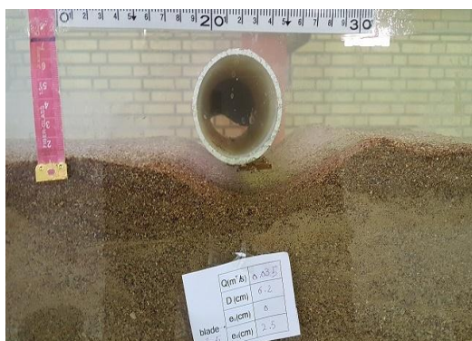
شکل ۶- آبشستگی در زیر لوله مستغرق با نصب تیغه بعد از آزمایش
