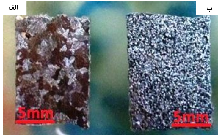
شکل ۶- ماکروساختار آلیاژ Al-4.8 wt.%Cu الف: بدون جوانه زایی ب: بعد از جوانه زایی در سرعت سرد شدن ثابت 0.19^{\circ}\text{C}/\text{sec}
