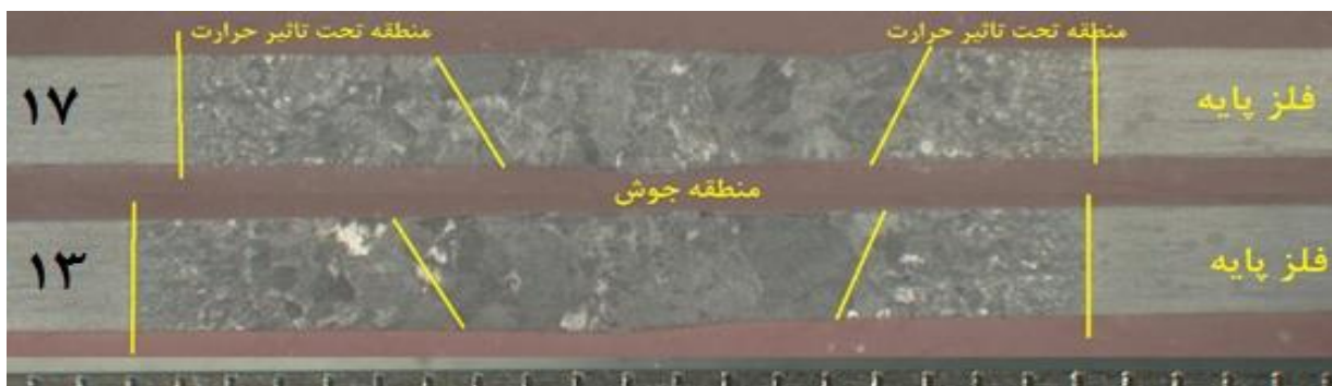
شکل ۸- تصویر ماکرو سطح مقطع نمونه شماره ۱۳ و ۱۷ جوشکاری شده با روش پلاسما
