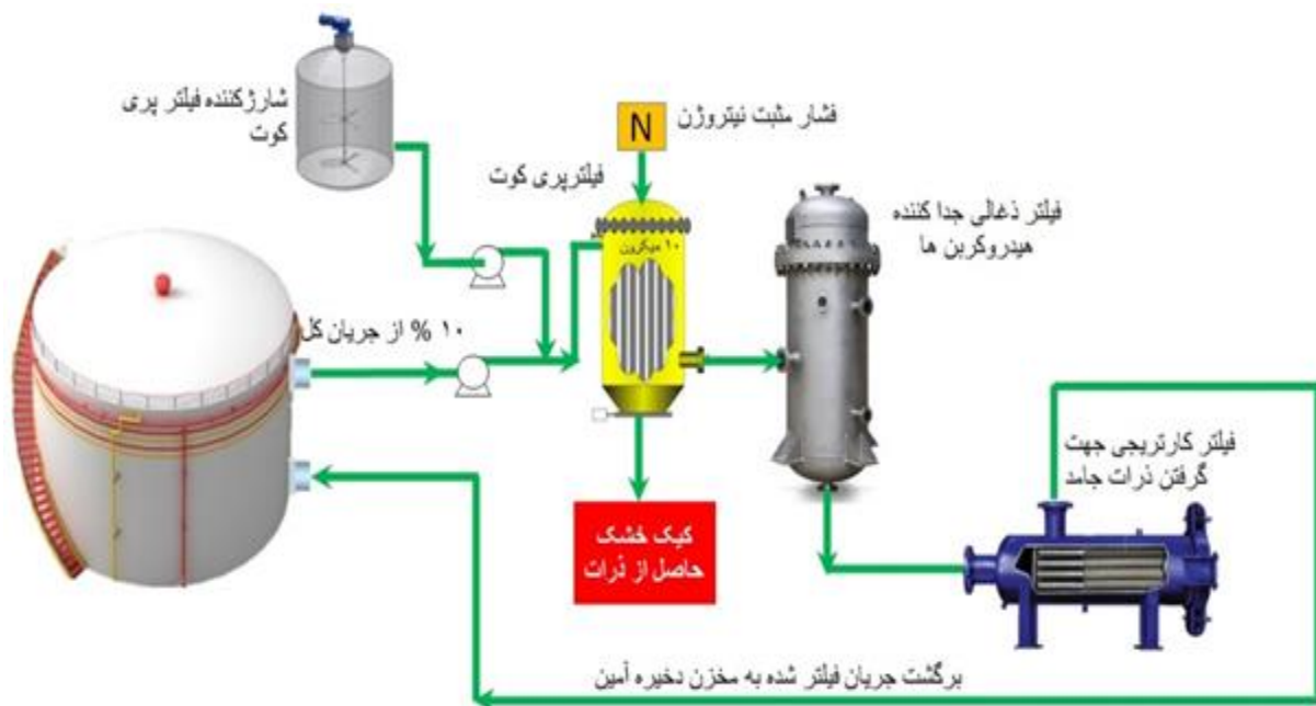
شکل ۱- چیدمان یک پکیج فیلتراسیون در پارس جنوبی که به منظور جداسازی ذرات ریز، هیدروکربن‌ها و ناخالصی‌های محلول آمین استفاده می‌گردد
