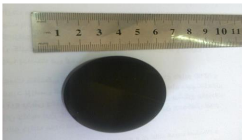
شکل ۲- تصویر نمونه پوشش دهی شده با روش PVD
