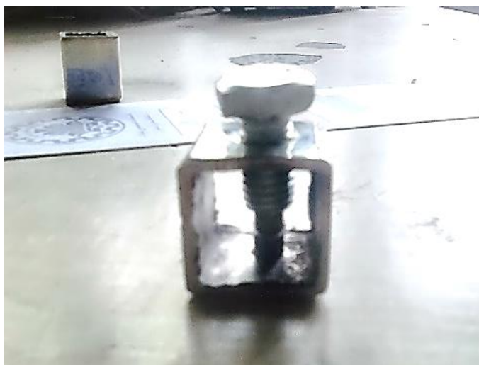
شکل ۱- نحوه قرارگیری نمونه‌ها در فیکسچر حین انجام اتصال
