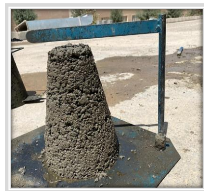
شکل 12: اندازه گیری اسلامپ بتن تازه
