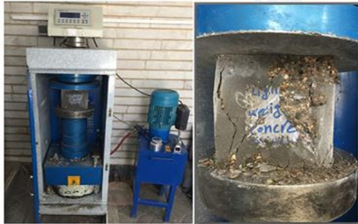
شکل ۵- آزمایش مقاومت فشاری بتن سبک با پوکه لیکا
