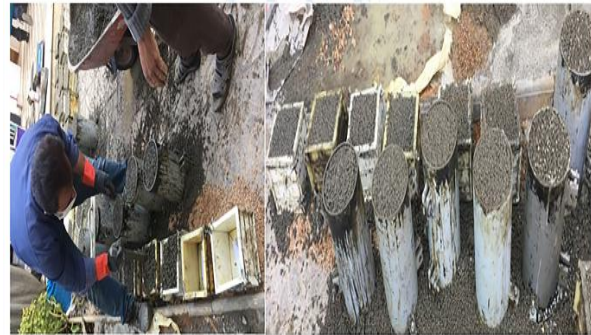
شکل ۴- نمونه‌گیری بتن سبک در قالب‌های مکعبی و استوانه‌ای
