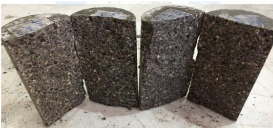
شکل ۷- دو نیم شدن نمونه استوانه‌ای بعد از آزمایش کششی
