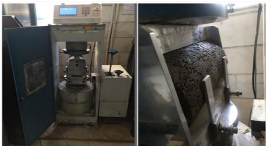
شکل ۶- دستگاه آزمایش مقاومت کششی نمونه استوانه‌ای
