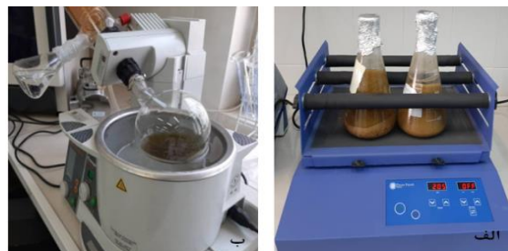
نگاره ۱: (الف) مخلوط شدن حلالها با گیاهان پودر شده جهت عصاره گیری، (ب) حلال پرانی عصاره ها در دستگاه تقطیر دورانی
