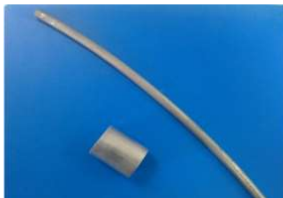
شکل (۱): تصویر ماکروسکوپی نمونه پرس سرد و اکستروود شده.
