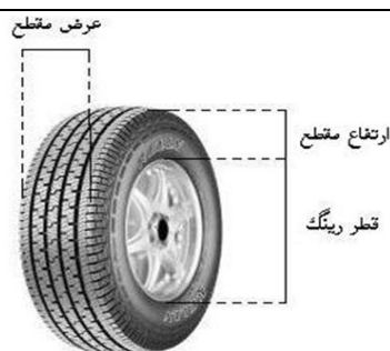
شکل (۴) مشخصات تایر مورد استفاده جهت تجزیه و تحلیل و ابعاد پد
