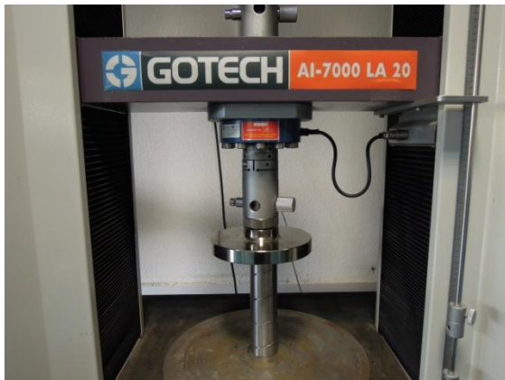
شکل (۷) یک دستگاه GOTECH – AL7000 در حال بار گذاری روی
