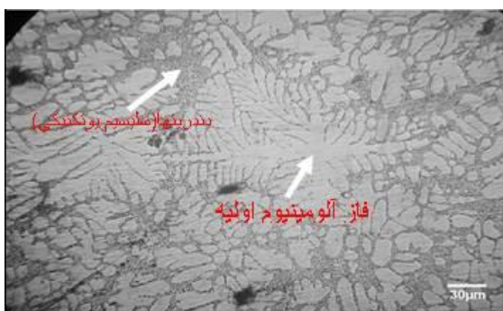
شکل (۲) ریزساختار آلیاژ آلومینیوم A360 در حالت ریخته‌گری معمولی در قالب فلزی با دمای بارریزی 670^{\circ}\text{C}
