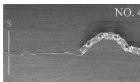
شکل (۲۵) حرکت سرپنتین ربات مارمانند بر روی سطح صاف.
