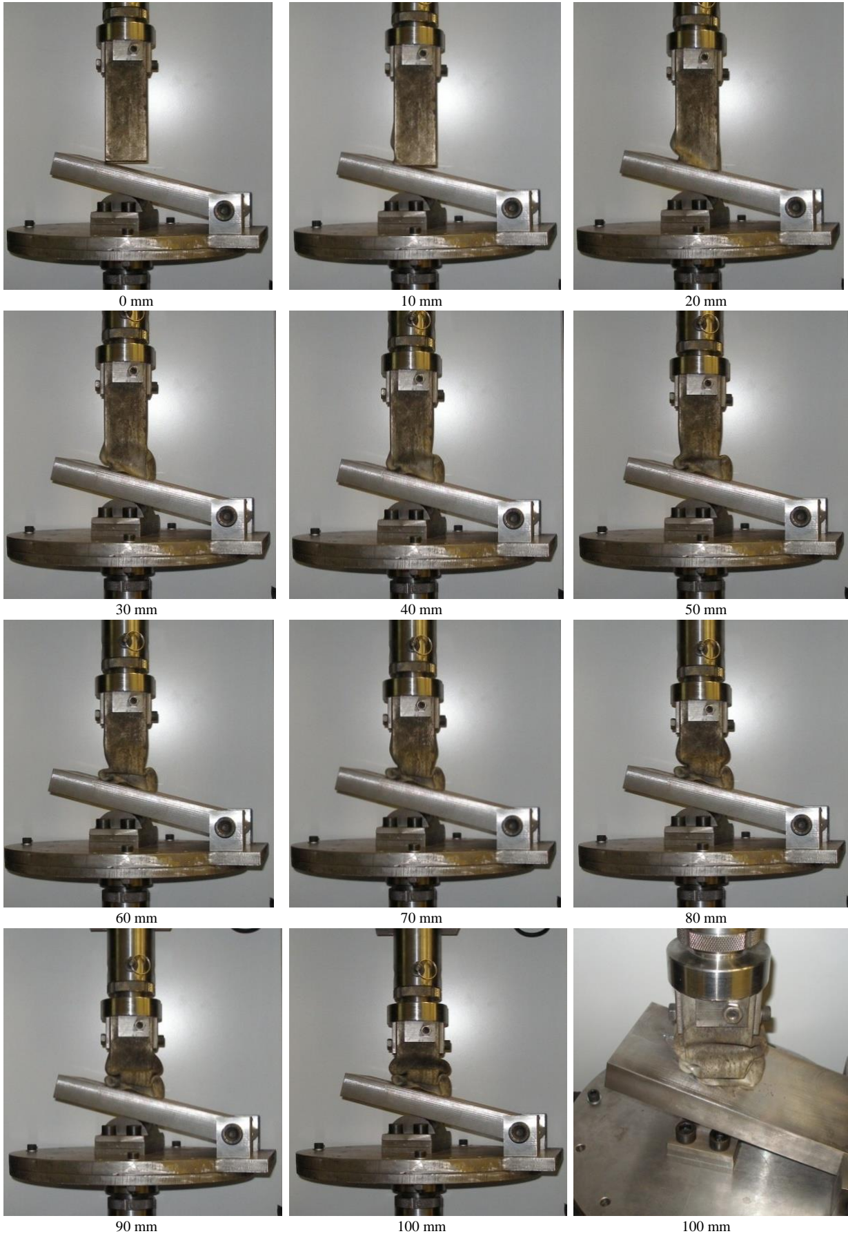
شکل (۷) تغییر شکل نمونه C1 در طول انجام آزمایش
