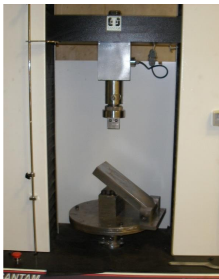
شکل (۴) تصویر فک بالا و فیکسچر پائین در حالتی که بر روی دستگاه آزمایش کشش نصب شده
