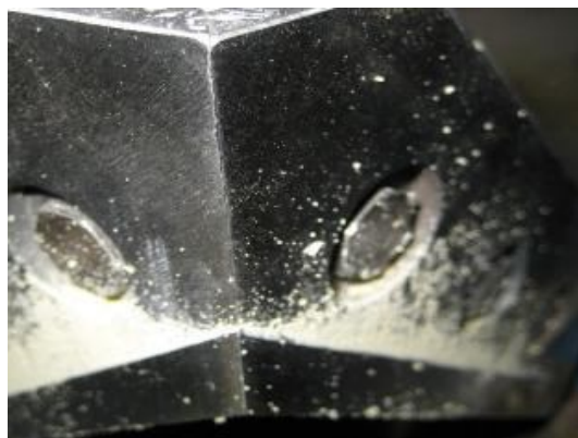
شکل (3) ذرات PVC چسبیده شده به تیغه‌های گیوتین.
