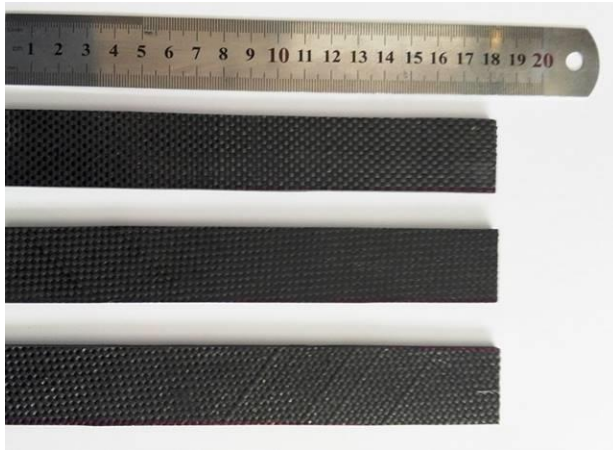
شکل (۱) نمونه‌های کامپوزیتی الیاف کربن/اپوکسی در ابعاد استاندارد.
