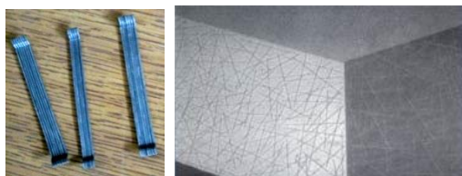
شکل (۲) نحوه پخش الیاف فولادی در بتن و شکل ظاهری الیاف
