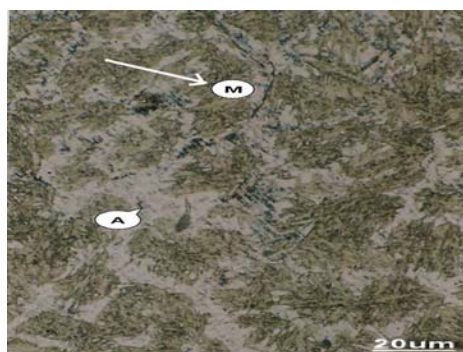
شکل (۷): ساختار تیغه عملیات حرارتی سخت کاری شده CK70 حاوی مارتنزیت (M) و آستنیت باقیمانده (A)
