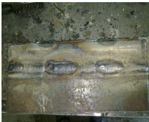
شکل (۲): تیغه فولاد St37، پس از روکش کاری سخت.
