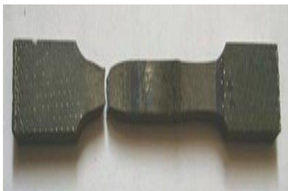
شکل (۱۱): محل گسیختگی نمونه‌های کشش
