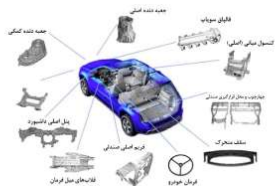
شکل (۱): برخی از کاربردهای آلیاژهای غیر آهنی در خودرو.
