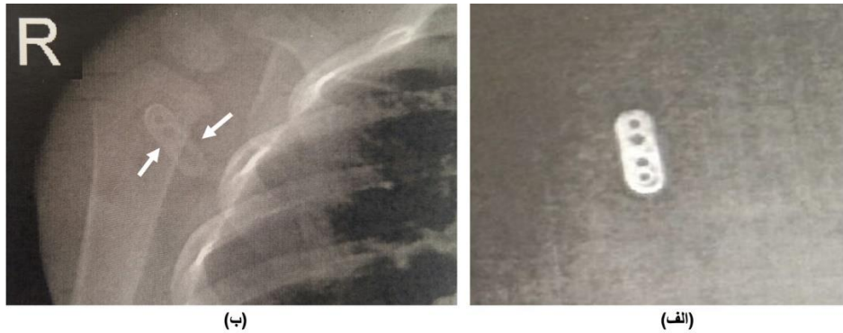
شکل (۷): تصاویر رادیوگرافی الف) ایمپلنت PEEK با پوشش SrO (ایجاد پوشش در دمای 70^{\circ}\text{C} و ب) قرارگیری ایمپلنت PEEK با پوشش SrO (ایجاد پوشش در دمای 70^{\circ}\text{C} روی استخوان).
