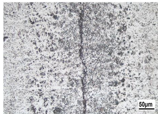
شکل (۳): تصاویر الف) میکروسکوپ نوری و ب) الکترونی روبشی درز اتصال نمونه 580T60M.
