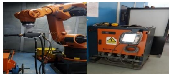
شکل (۳): تصاویری از پاشش حرارتی پوشش کاربید تنگستن به وسیله‌ی ربات صنعتی
