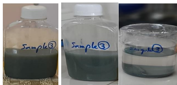
شکل (۴): روغن پایه حاوی نانو ذرات اصلاح سطح نشده، (ب) روغن پایه حاوی نانو ذرات پس از اصلاح سطح و (ج) روغن پایه حاوی نانو ذرات پس از اصلاح سطح شده بعد از گذشت ۱ ماه
