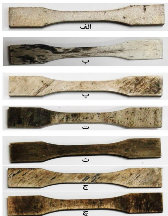
شکل (۵): نمونه های پیش از آزمون: (الف): ریخته گری، (ب): بعد از نورد راستای RD، (پ): بعد از نورد راستای ۴۵ درجه، (ت): بعد از نورد راستای TD، (ث): بعد از آنیل راستای RD، (ج): بعد از آنیل راستای ۴۵ درجه و (چ): بعد از آنیل راستای TD
