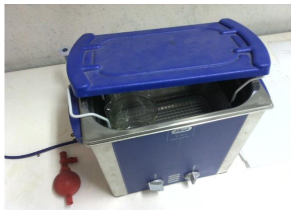
شکل (۲): دستگاه التراسونیک به کار گرفته شده به منظور تکمیل فرایند تشکیل نانوذرات فریت
