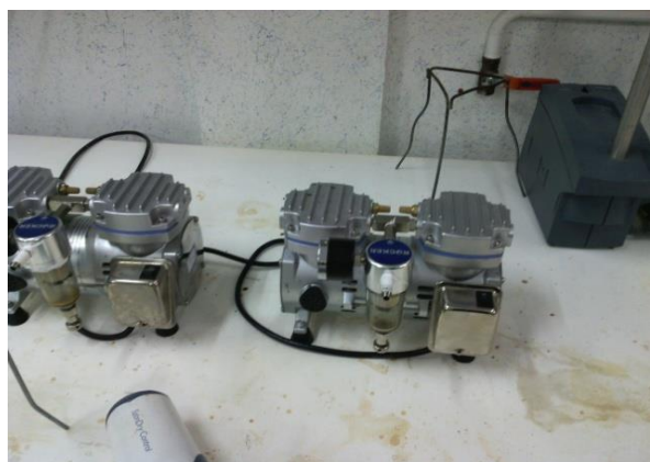
شکل (۳): دستگاه پمپ و کیوم مورد استفاده در آب گیری سریع از رسوبات
