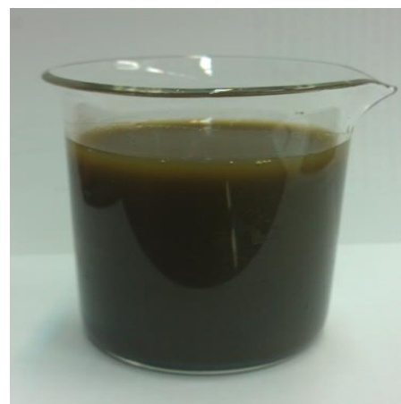
شکل (۱): محلول اولیه تهیه شده از روش هامرز برای تهیه اکسید گرافن بعد از واکنش گرافیت با پرمنگنات
