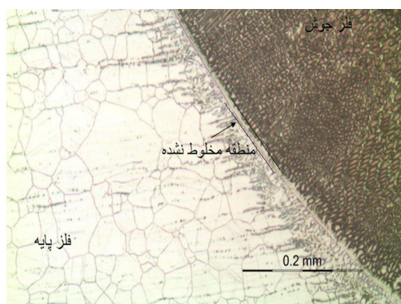
شکل (۱۴): تصویر میکروسکوپ نوری، فصل مشترک فلز پایه 304L و فلز جوش ERNiCr-3
