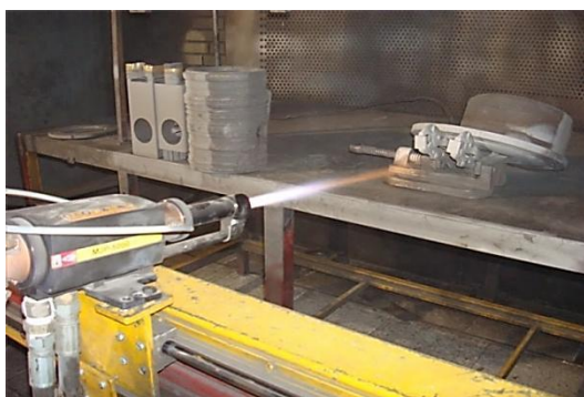
شکل (۱): عملیات پوشش دهی پاشش حرارتی HVOF نمونه های اینکونل
