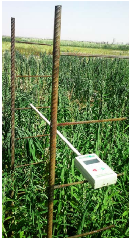
شکل ۱- پایه‌های تعبیه شده و نحوه قرارگیری سیتومتر خطی جهت اندازه‌گیری تشعشع لایه‌های مختلف کانوپی در هر کرت آزمایشی
