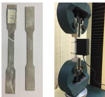
شکل ۲. آزمایش کشش نمونه آلومینیومی
