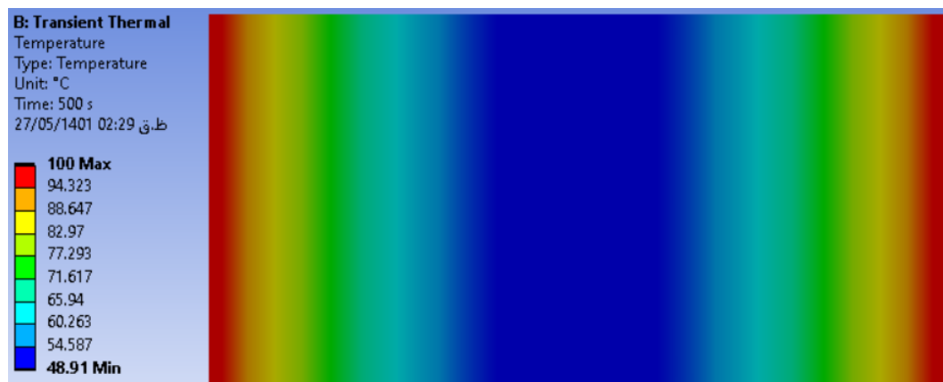
شکل ۵- کانتور توزیع دما در صفحه در صورت اعمال شرط مرزی دما در دو لبه غیرمجاور
