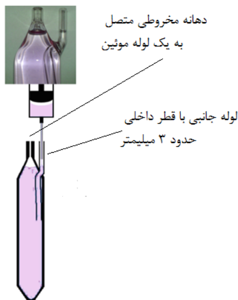
شکل ۱ طرحواره ظرف طراحی شده برای انجام میکرواستخراج
